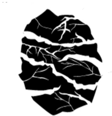
Figura 3. Porosidad del grano de carbón activo.
