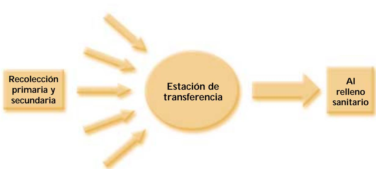
Así, la estación de transferencia se constituye en una interfase entre la recolección, transporte y disposición de los RSM (ver Figura 3.2), buscando los siguientes beneficios esenciales:
