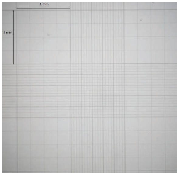
Figura N° 1. Cámara de Neubauer.
