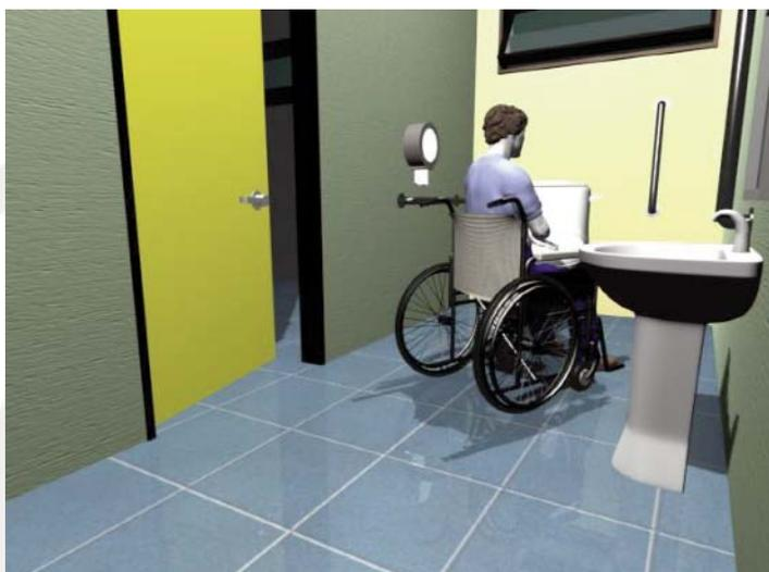
El ancho mínimo de la entrada debe ser de 90 cm, la puerta debe abrir hacia afuera o ser plegable, y como se señala en el apartado de complementarios, debe contar con manijas de tipo palanca con botón de presión, ubicadas a una altura de 90 cm, de manera que puedan ser accionadas con poco esfuerzo con una sola mano, codo, pierna o mandíbula según sea del caso.
