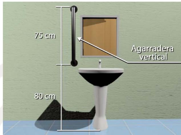
La grifería deberá ubicarse a 50 cm máximo del borde del lavatorio y el accionado del grifo debe ser de palanca, presión, célula fotoeléctrica o similar.
