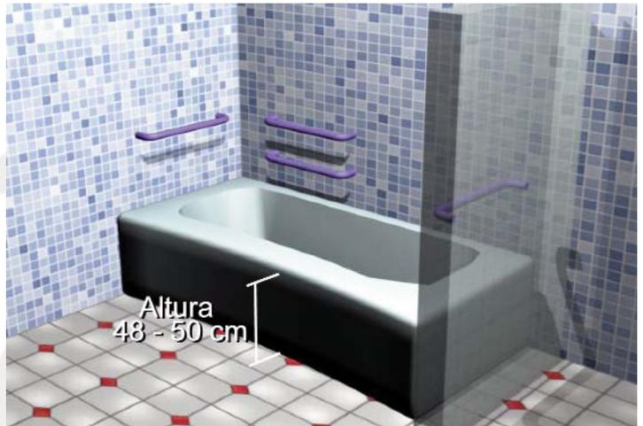
La bañera debe tener 4 agarraderas horizontales, 1 en la cabecera, 1 en la piecera, ambas de 60 cm longitud y a una altura comprendida entre 84 cm y 92 cm respecto al nivel del piso terminado; y dos lateralmente de 60 cm de longitud ubicadas una a 20 cm por encima del borde superior de la bañera y la otra a una altura comprendida entre 84 cm y 92 cm desde el piso terminado.
