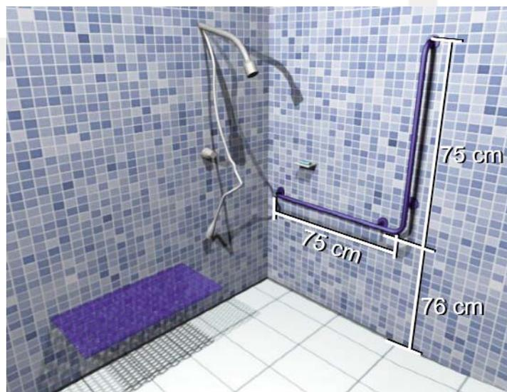
Como parte de los accesorios, tiene que tener como mínimo una jabonera a una altura máxima de 90 cm y tres percheros siendo uno de ellos específico para muletas, ortesis y similares a una altura de 120 cm, todos medidos desde el nivel del piso terminado, además es recomendable que cuente con una ducha del tipo teléfono, para que facilite su uso desde una posición sentada.
