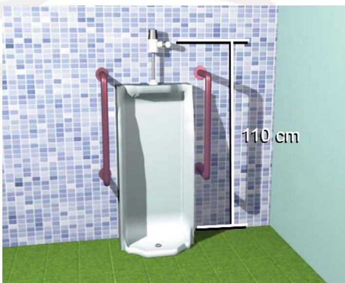
El mingitorio debe disponer de dos agarraderas verticales de 80 cm de longitud, separadas por 80 cm entre ellas y deberán separarse 30 cm de la pared de fondo ubicándose a una altura de 70 cm desde el nivel del piso terminado.
