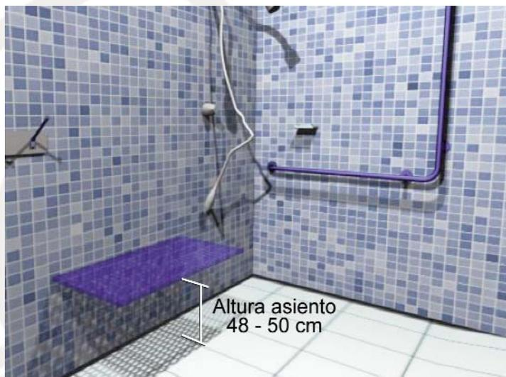
Debe contar con una agarradera en forma de "L" de 75 cm de longitud en ambos extremos, y ubicarse a una altura de 76 cm desde en nivel del piso terminado.
